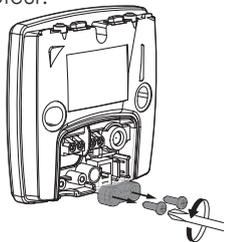
2- Découpez à l'aide d'un cutter le capuchon d'étanchéité et faites passer le câble de l'appareil à raccorder.
