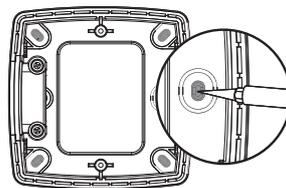
2- Dans le cas d'une sortie de câble dans le mur, découpez la zone sécable au dos du socle mural.
