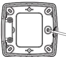
4- A l'aide des 2 vis de montage fournies, montez le récepteur sur la boîte d'encastrement.
