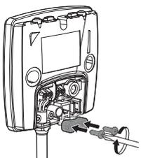
6- A l'aide des 2 vis de montage fournies, montez le récepteur sur la boîte d'encastrement.
