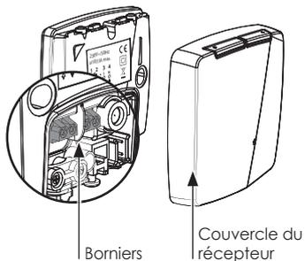
**Zone de câblage à l'arrière du récepteur**
