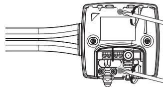
**Note :** Dans le cas d'une sortie de câble par l'arrière, aucun système d'étanchéité et d'anti-traction n'est nécessaire.
