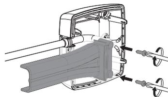
4- A l'aide des 2 vis de montage fournies, montez le récepteur sur la boîte d'encastrement.
