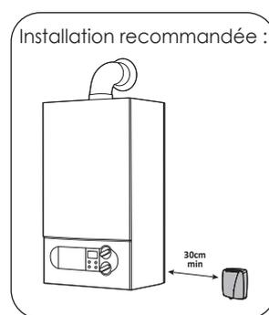
**IMPORTANT :** le récepteur doit être installé à au moins 30cm de tout obstacle : objet métallique, boîtiers muraux, chaudière... **NE PAS INSTALLER LE RÉCEPTEUR SUR UNE SURFACE CHAUDE.**
