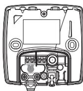
3- A l'aide des 2 vis de montage fournies, montez le récepteur sur la boîte d'encastrement.
