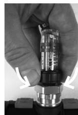
**3.** Utiliser le volant noir pour régler le débit de la boucle, en vissant ou dévissant jusqu'à voir le flotteur positionné dans la fenêtre de l'anneau indicateur
