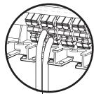
**3-** Insérez le serre-câble dans son encoche. Appuyez fortement sur le serre-câble jusqu'à enclenchement de celui-ci.
