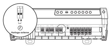
Raccordez les 2 fils du contact NO de l'horloge sur les 2 bornes d'entrée Éco de la centrale de régulation.
