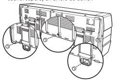
DIN pour coffret métallique ACOME (ou sur le rail DIN au mur) et centrez-le.
