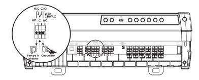
Gestion du mode chauffage asservi à une chaudière murale par un contact libre de potentiel. Si votre chaudière murale possède une entrée thermostat sur 2 bornes, retirez le shunt qui les relie, puis raccordez les 2 fils venant de la centrale de régulation pour plancher chauffant/rafraîchissant comme suit :
