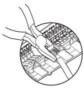
Une fois le raccordement terminé, remettez le capot inférieur en place et fixez-le avant de mettre l'appareil sous tension.
