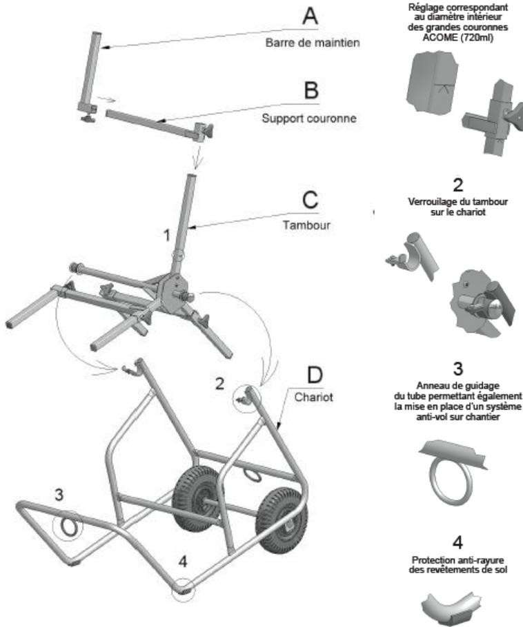
1. Positionnez les 3 barres (B) sur les repères correspondant au diamètre intérieur des couronnes (1)
